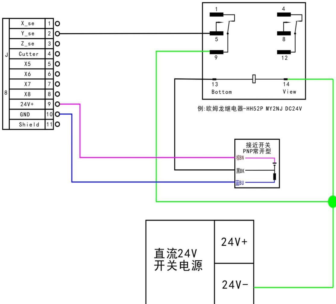
2 对刀端子：简易对刀台接线示例
